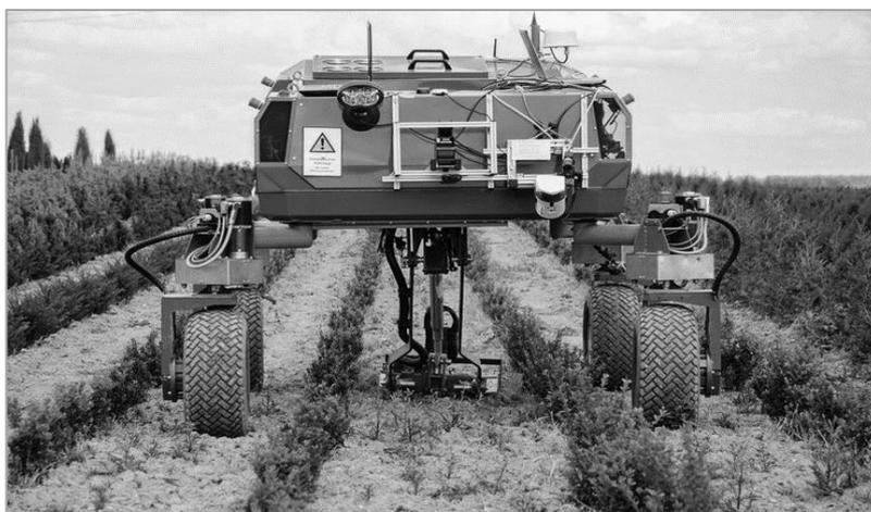
**Рисунок 3 – Агробот BoniRob компании BOSCH (Германия)**
